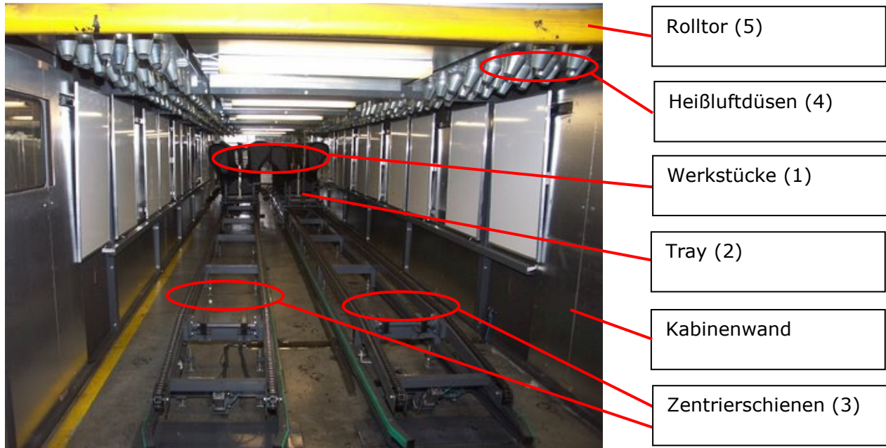
Bild 1: Trocknungsanlage mit Details der konventionellen Trocknung.
